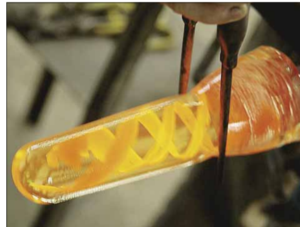
Hals. Mönsterslingorna består av svart krossat glas som välsats in under ett moment i arbetet.
